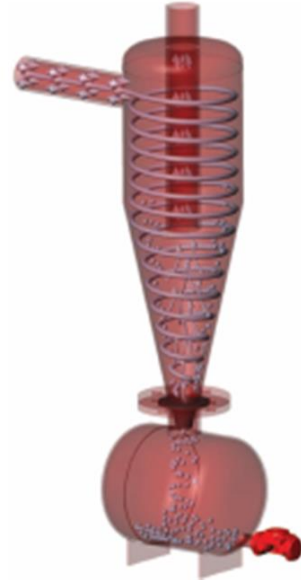
HİDROSİKLON (KUM SEPERATÖRÜ) 2000 Serisi ÇALIŞMA PRENSİBİ
